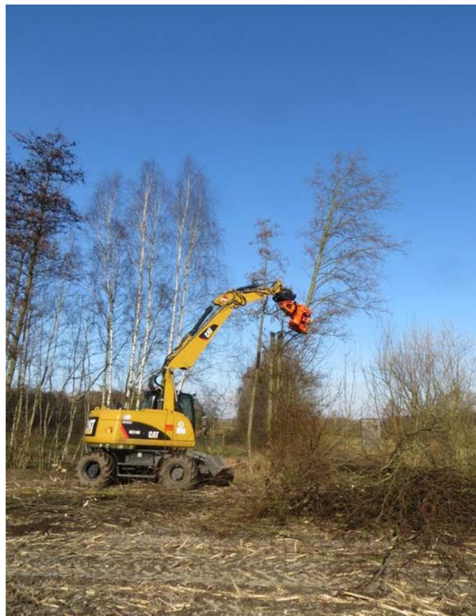
Abbildung 6: Gehölzpflege (Erlenrückschnitt) mit Baumschere am Mobilbagger (2016)
